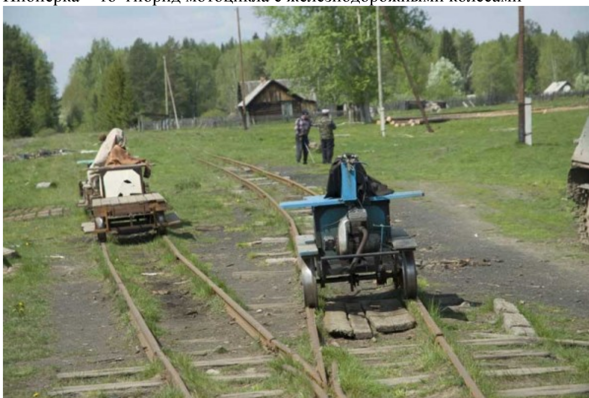
Пионерка - то гибрид мотоцикла с железнодорожными колесами
