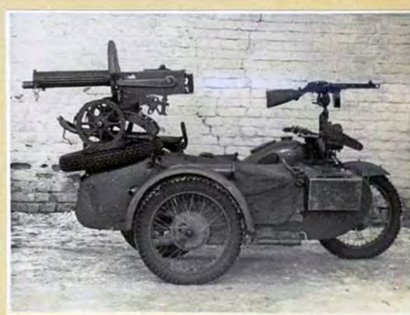
фото № 5. Для перебросок на короткие дистанции пулемет вместе со станком укладывался на заднюю часть коляски.
